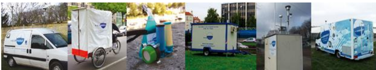
Les dispositifs pour les campagnes : laboratoire mobile, vélo de livraison, tubes à diffusion passive, remorques, armoires, camion (source : Airparif)
